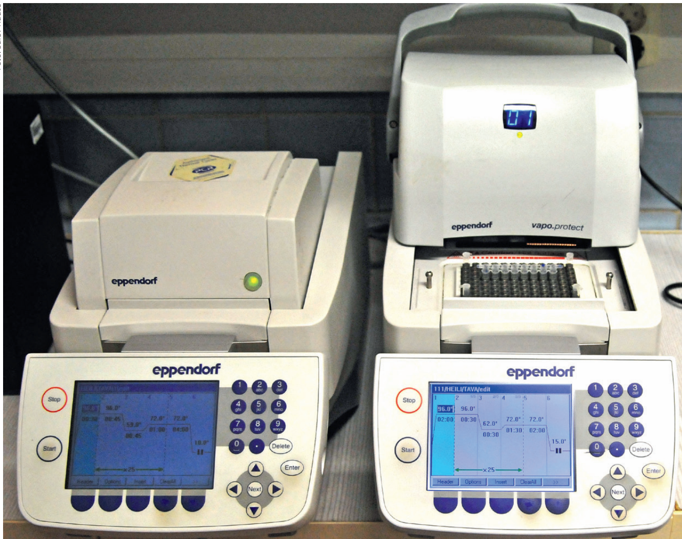
◇ 1. Nüüdisaegsed PCR-masinaid teaduslaboris. PCR-i ekraanil on näha polümeraasi ahelreaktsiooni tsükli aegade, iga etapi vajalik temperatuur ning tsükli arv, et amplifitseerida ehk kordistada uuritav DNA vajalikus hulgas
