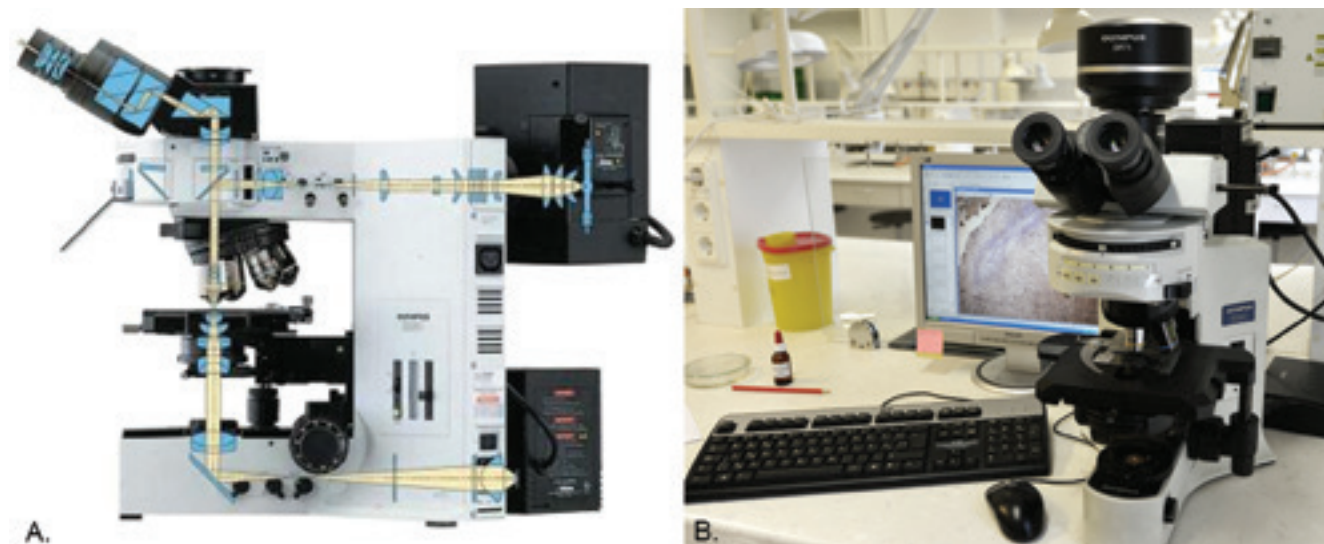
◇ 4. Nüüdisaegne fluorestsentsmikroskoop. A – skeemil on näidatud nähtava valguse teekond (alumine valgusallikas) ja fluorestsentsvalguse teekond (ülemine valgusallikas) läbi objektiivi objektini ja registreeriva okulaarini. B – fluorestsentsvõimekusega uurimismikroskoop Olympus BX41 (Jaapan), arvutikuva inimese emaka endomeetriumi (kasutatud programmi CellB, Soft Imaging System, Olympus).
